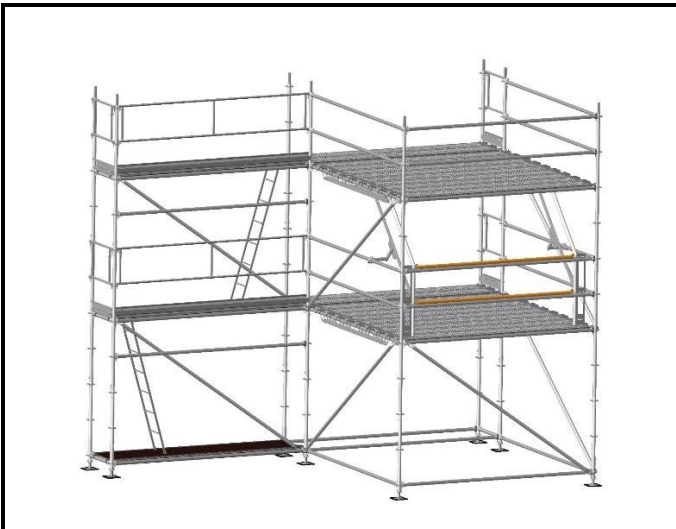
5 Assembler les deux portiques basculants par des longerons de 2,50m
